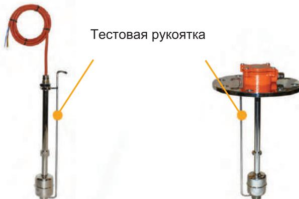
С помощью интегрированной в Датчик уровня тестовой рукоятки ½ /DN100 возможно произвести проверку работоспособности без демонтажа прибора или заполнения и опорожнения емкости.
