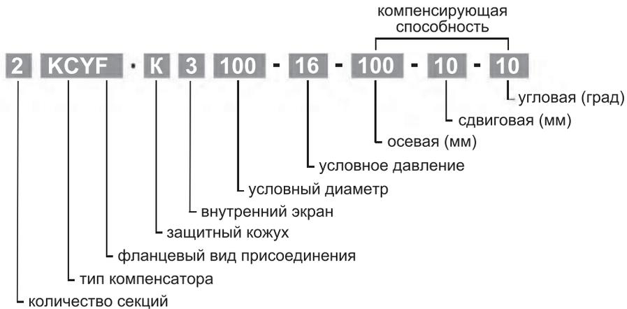
Пример обозначения универсального двухсекционного компенсатора с условным диаметром Ду 100, условным давлением Ру 16 Бар, компенсирующей способностью: осевой :100 мм, сдвиговой: 10 мм, угловой: 10 градусов, концевыми деталями-фланцами (F), защитным кожухом (K), внутренним экраном (3) : 2КСУF.К3 100-16-100-10-10
